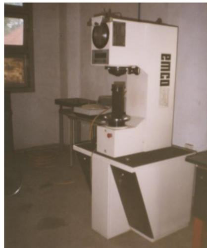
Gambar 5. Alat uji kekerasan
