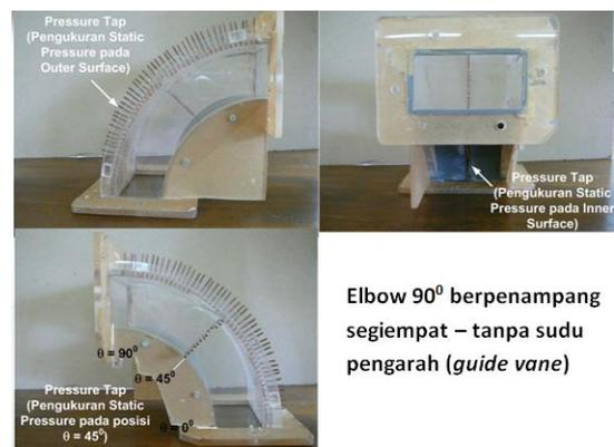
**Gambar 5b.** Elbow 90° tanpa sudu pengarah
