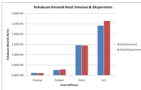
**Gambar 5.** Kurva kekakuan dinamik hasil simulasi & eksperimen [8] untuk benda kerja tanpa dan dengan 3 jenis *stiffener*.
