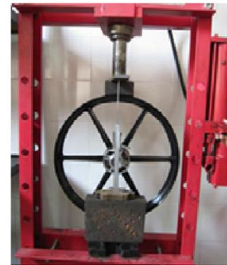
Gambar 3. Real Experiment Pengujian Uji Tekan
