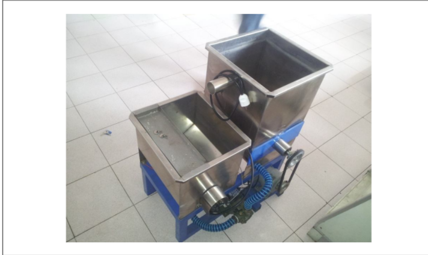
Gambar. Mesin Penurun kandungan sianida pada kacang koro pedang
