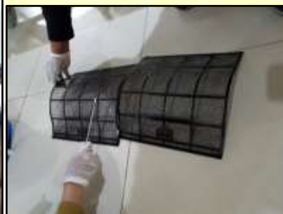
Pengambilan & Pembersihan Sampel Filter AC ( swab ) Sebelum Pembersihan
