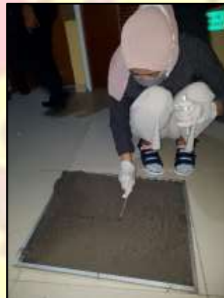
Pengambilan Sampel Filter AC (swab) Sebelum Pembersihan
