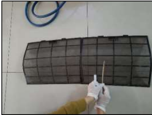
Pengambilan Sampel Pada Filter AC
