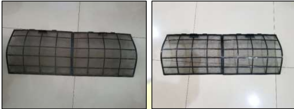
Gambar 4.24 Filter AC Sebelum (Kiri) dan Sesudah (Kanan) Pembersihan
