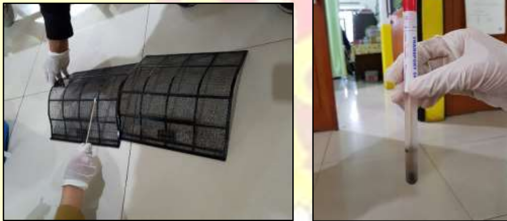
Gambar 4.15 Pengambilan Sampel pada Filter AC
