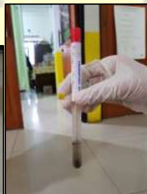
Pengambilan & Pembersihan Sampel Filter AC ( swab ) Sebelum Pembersihan
