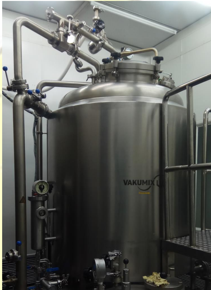
Gambar I.1 Mixing Tank 1000 Liter yang digunakan di Departemen Produksi Vaccine
