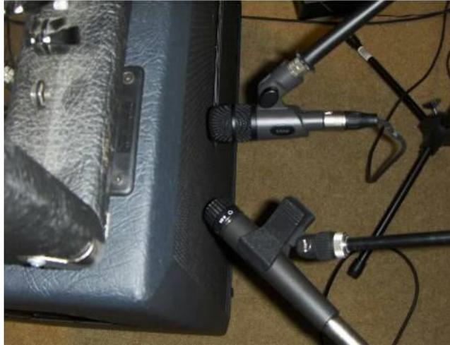
Gambar. 2.1.2. Contoh penempatan *mic* di todong ke speaker
