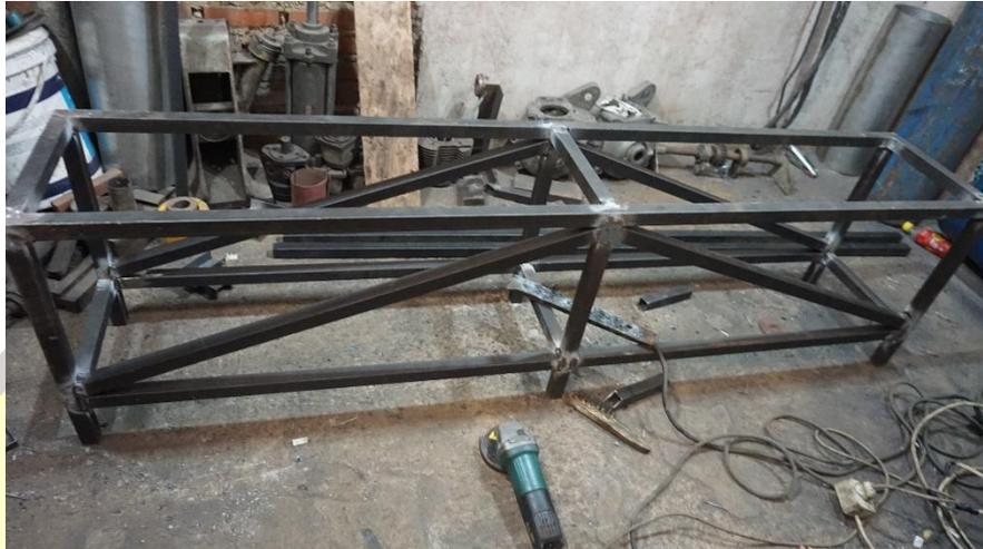
**Gambar 4.7** Rangka Konveyor
