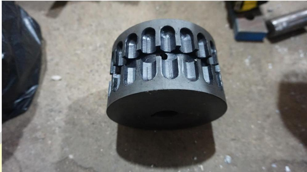
**Gambar 4.9** Hasil Pembuatan Pola Sproket
