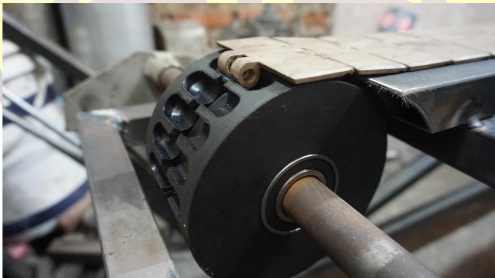
**Gambar 4.10** Penyambungan Sproket dan As
