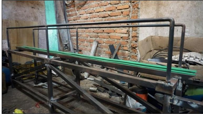
**Gambar 4.14** Konveyor Setelah Dipasang Baja Pipa Pembatas
