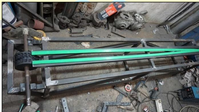
**Gambar 4.13** Konveyor Sebelum Dipasang Baja Pipa Pembatas
