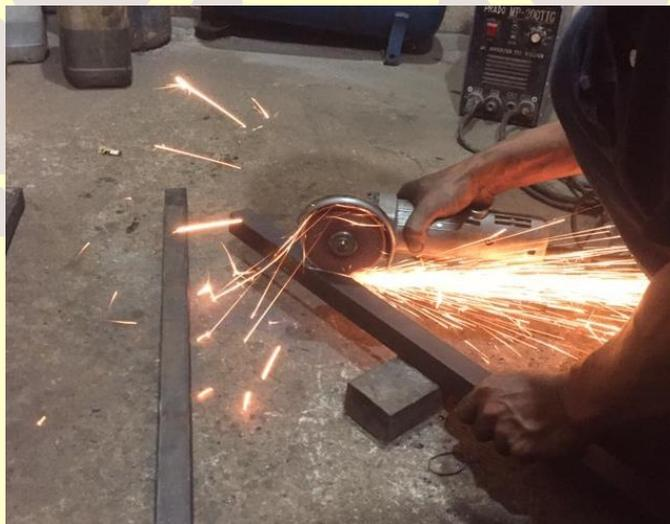
**Gambar 4.4** Proses Pemotongan Baja *Hollow*
