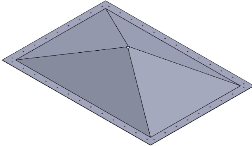
Pembuatan kubah yang menggunakan material komposit adalah lebih ringan dan mudah di perbaiki apabila terjadi kebocoran atau kehilangan gas pada digester biogas. Langkah-langkah pembuatan kubah komposit ini yaitu kriteria perancangan, merancang design kubah akan seperti apa bentuknya, mendesign atau membuat cetakan, pembuatan kubah komposit yang menggunakan bahan dari serat *fiberglass*.
