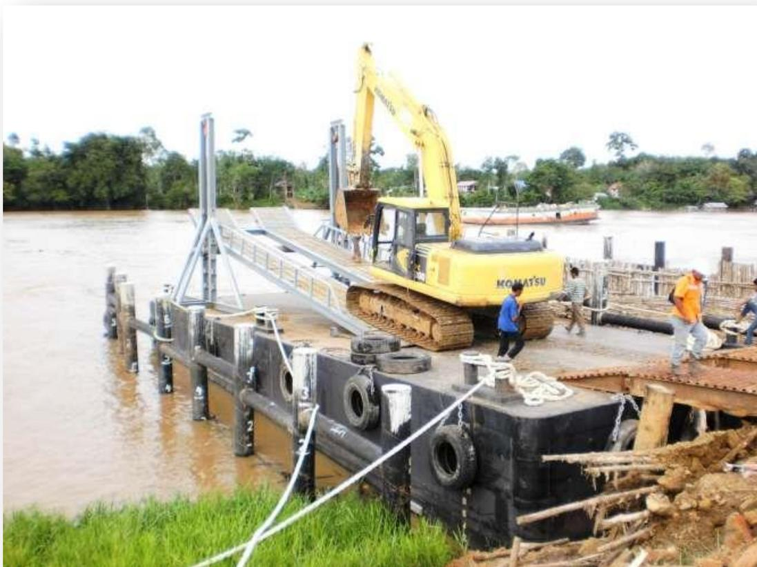
**Gambar 1.1** *Ramp Gate Door* penghubung antara dermaga ke kapal tongkang
