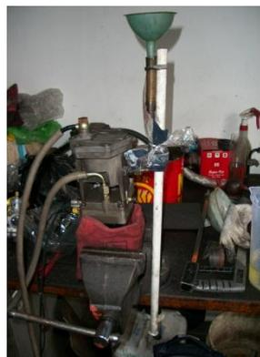
**Gambar 2.65** *Alat Ukur Flowmeter Yang Digunakan di LIPI*
