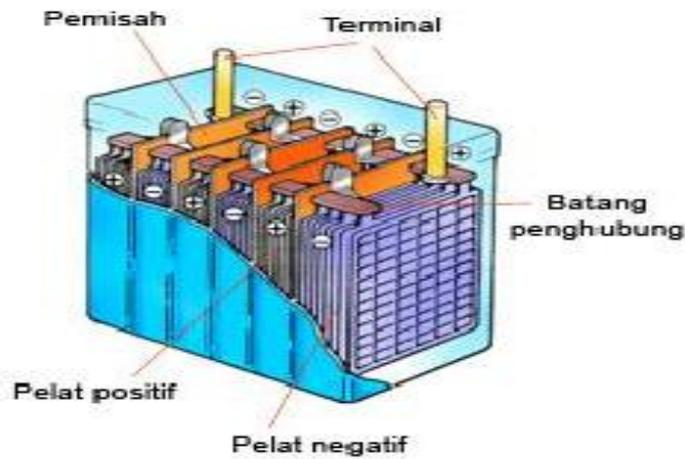
**Gambar 2.28** *Konstruksi Baterai*
