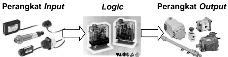
Gambar 2.7 Sistem kontrol dengan menggunakan relay
