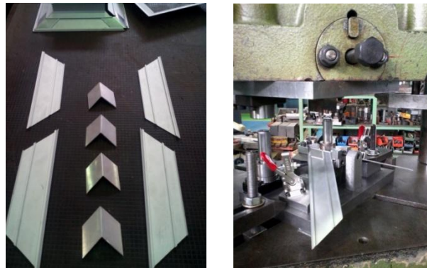
Gambar 4.11 Daun Diffuser Saat Akan Dipress .
