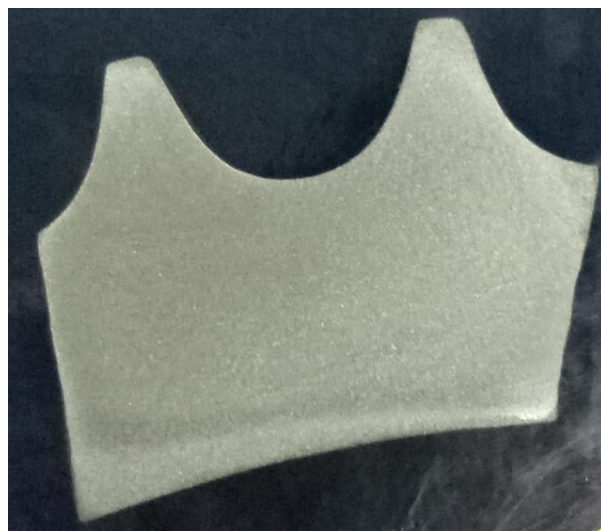
Gambar 4.2 Struktur makro sprocket lokal
