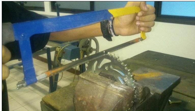
Gambar 3.6 Proses pengambilan sampel spesimen uji.
