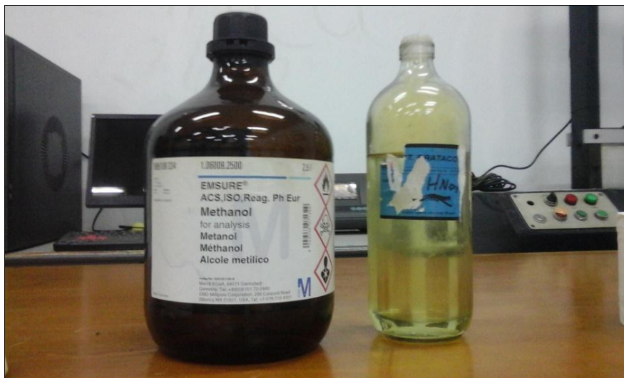
Gambar 3.13 Asam Nitrat ( \text{HNO}_3 ) dan Methanol untuk proses etsa
