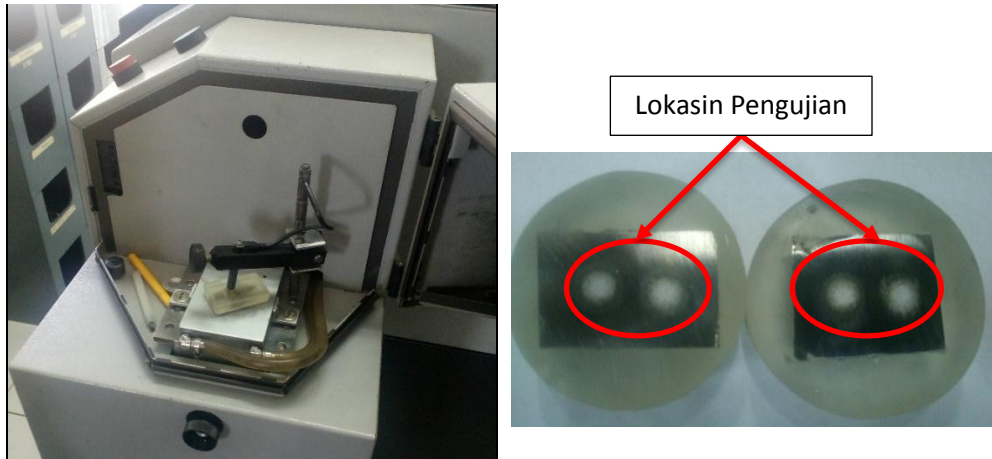
Gambar 3.4 Spesimen diatas meja uji mesin spectrometer .
