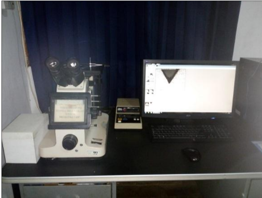
Gambar 3.16 Mikroskop optik untuk pengamatan dan pengambilan foto struktur mikro yang diamati.
