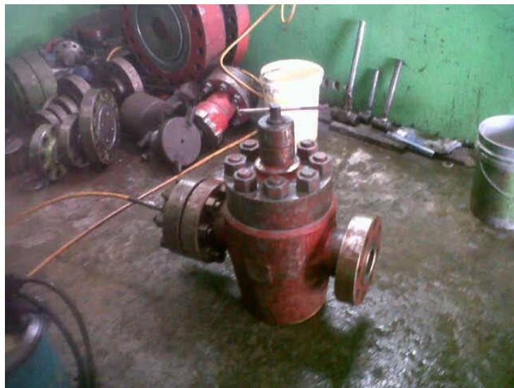
Gambar 1.4 pengetesan Gate valve di dalam ruangan hydrotest
