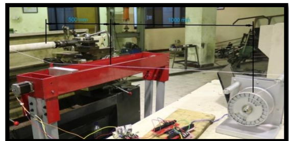
Gambar 3.6 Penempatan tensioner mesin filament winding
