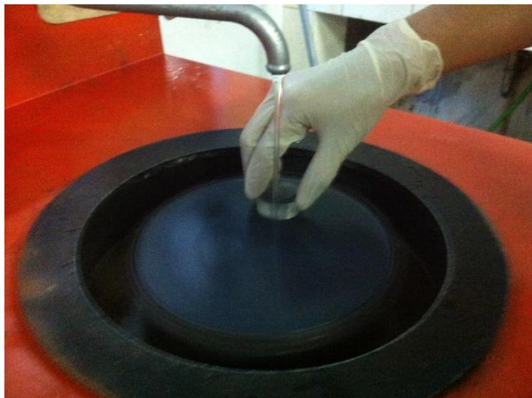
Gambar 3.11 Proses Pengampelasan (*Grinding*)
