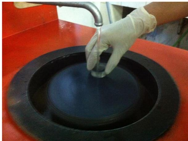
Gambar 3.13 Proses Pemolesan (*Polishing*)
