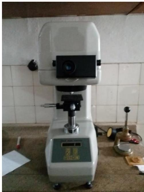
Gambar 3.18 Mesin Uji Kekerasan Vickers
