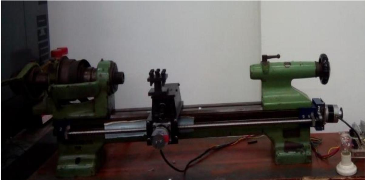
**Gambar 3.41 Rakitan eretan melintang dan eretan memanjang yang sudah dipasang pada mesin bubut schaublin 102**
