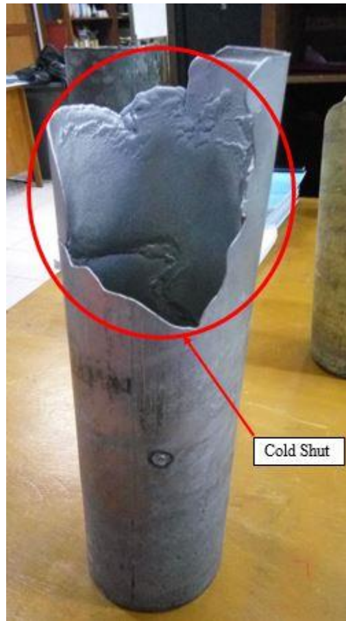
Gambar 4.8. Cacat Cold Shut
