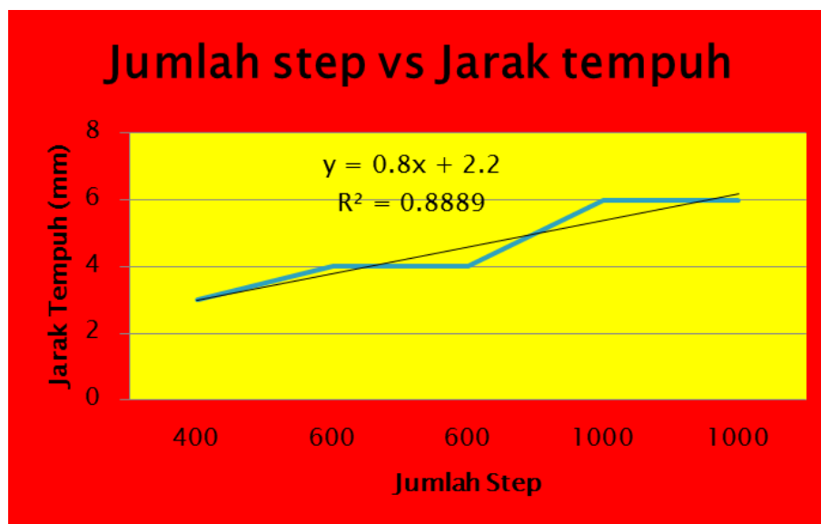
Grafik 4.1 Data hasil pengujian gerak meja kerja mesin frais dengan jumlah step yang berbeda-beda dan delay yang sama dalam arah sumbu X+
