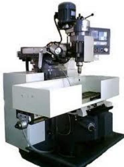
Gambar 2.5 Bentuk mesin frais CNC
