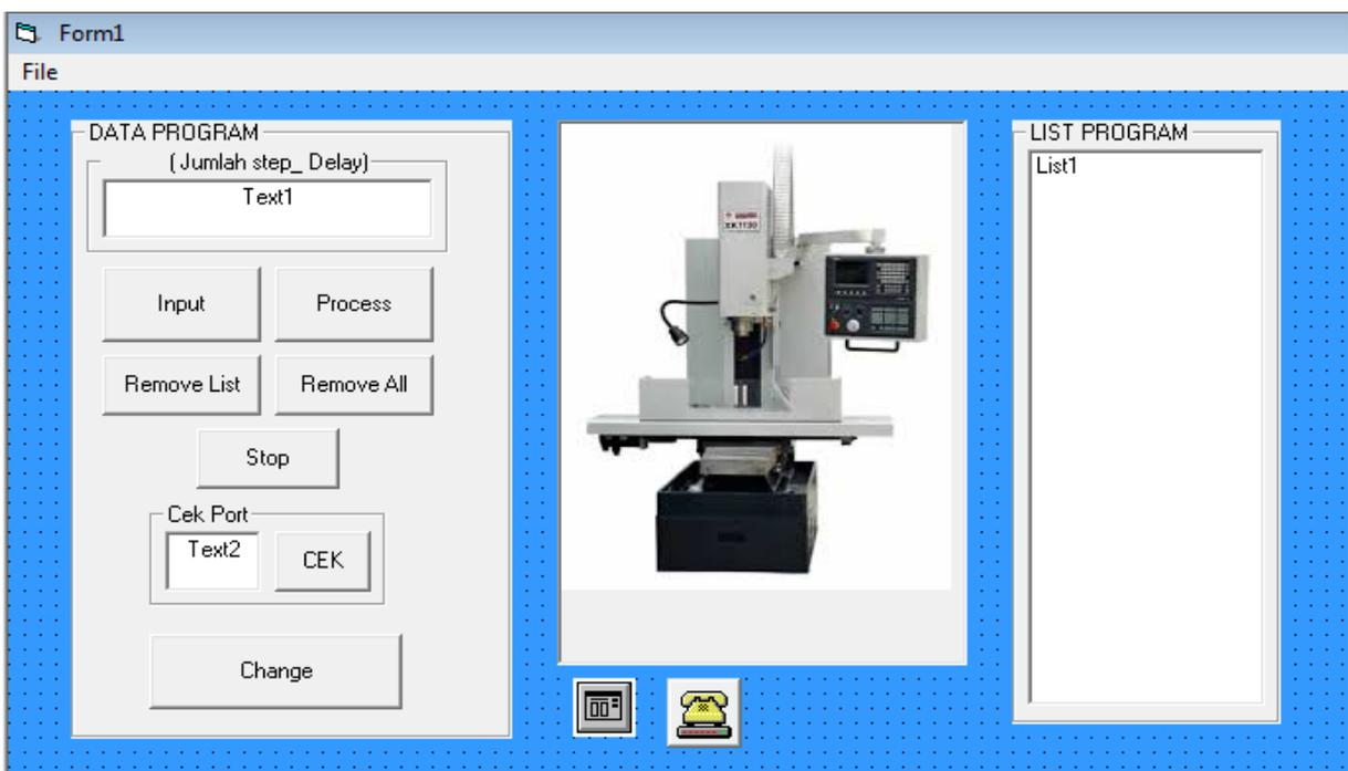
Gambar 3.14 *Form* pengendalian gerak meja kerja mesin frais dalam arah sumbu-x
