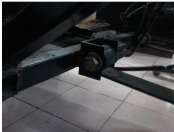
Gambar 5. 13 dudukan leaf spring bagian depan
