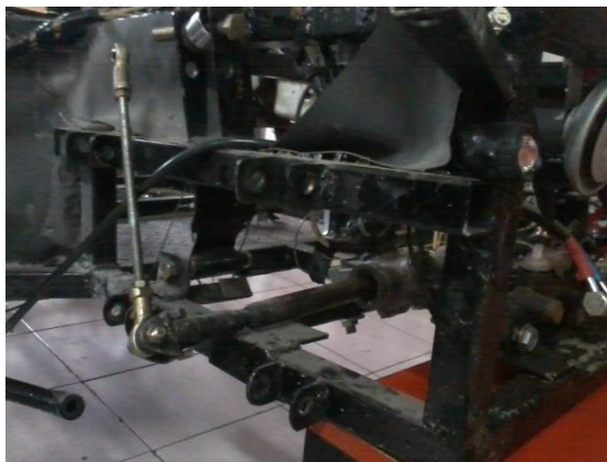
Gambar 5. 12 posisi dudukan arm suspensi
