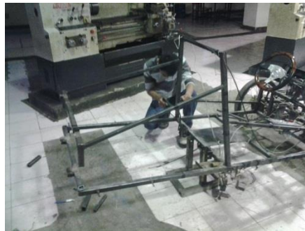
Gambar 5. 10 rangka bagian belakang
