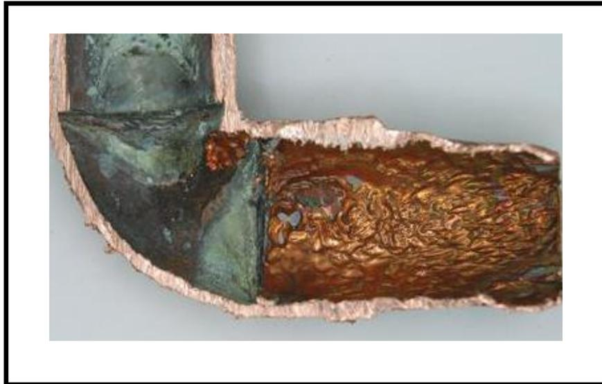
**Gambar 2.10. Mekanisme korosi erosi pada pipa**
