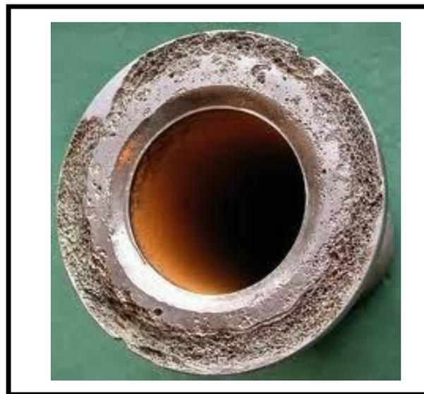
**Gambar 2.18. Korosi Celah Pada Sambungan Pipa**
