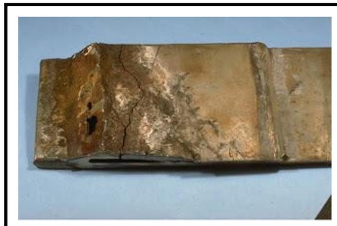
**Gambar 2.15. Korosi SCC Pada Sebuah Logam**
