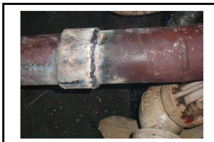
**Gambar 2.13. Korosi Galvanic pada sambungan pipa**
