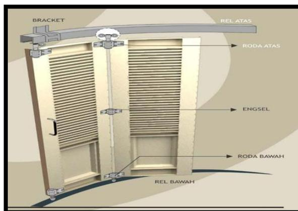
**Gambar 4.4** slider pada pintu sliding
