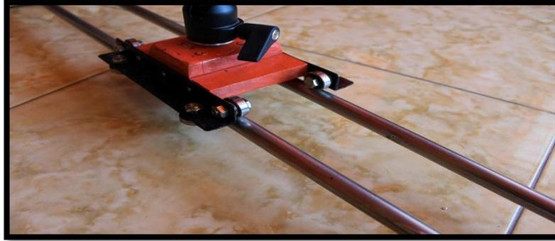
**Gambar 4.5** Mekanisme Slider Pada Dudukan Camera
