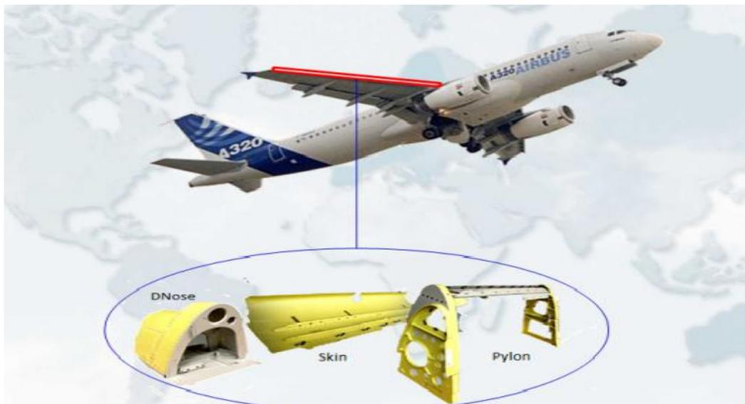
Gambar 1.1. Ilustrasi Struktur Sayap Pesawat *Airbus A320*
