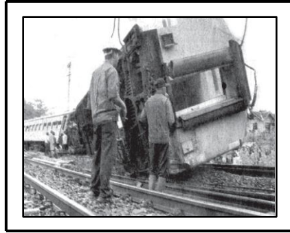
Gambar 2.7 Gerbong kereta api terguling dari relnya. Salah satu penyebab terjadinya kecelakaan kereta api karena fasilitas umum ini kurang terawat.
